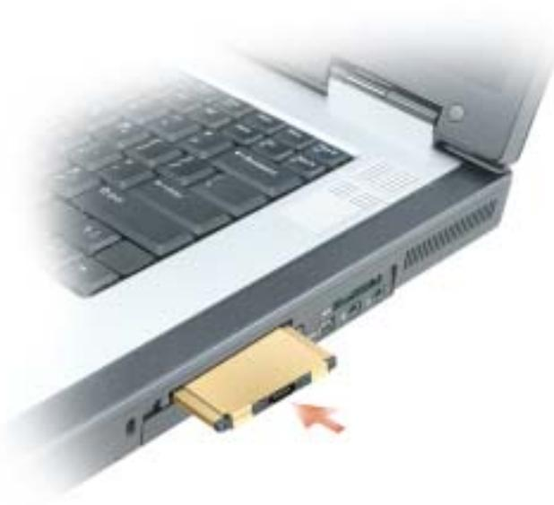
El equipo reconoce la mayoría de las tarjetas PC y carga automáticamente el controlador de dispositivos adecuado. Si el programa de configuración le pide que cargue los controladores del fabricante, utilice el disco o el CD incluido con la tarjeta PC.
