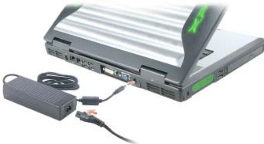
El adaptador de CA convierte la corriente alterna en la corriente continua que necesita el equipo. Puede conectar el adaptador de CA al equipo independientemente de que esté encendido o apagado.
